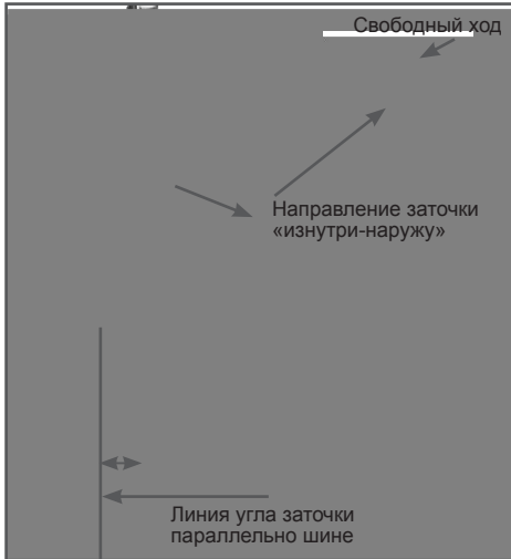
Рис. 16 Определение угла заточки
