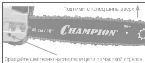
Рис. 5 Регулировка натяжения цепи
